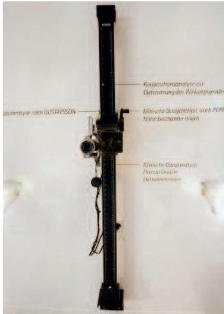
2 Eine besondere Kameralagerung sollte die Kamera bei der Bewegungsanalyse im rechten Winkel zum Objekt ausrichten.
